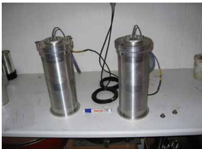
Figur 3. Semi-adiabatisk kalorimeter (aktiv og passiv målecelle), som beskrevet i DS/EN 196-9.
