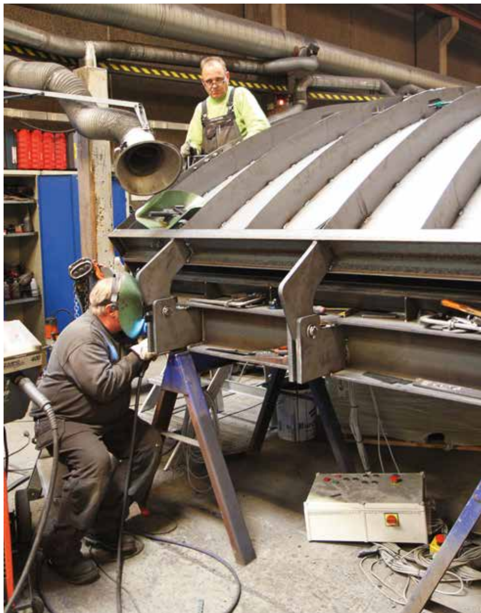
⬆ Stor nøjagtighed i smedearbejdet giver en kvalitet, som udlandet gerne vil betale for. Her fremstilles forme til tunnelementer.
